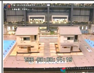
加振前後の写真(右側の建物は無補強の建物) 提供 防災科学技術研究所 Eーディフェンス
