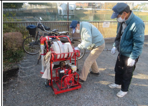
D級ポンプ点検の様子
