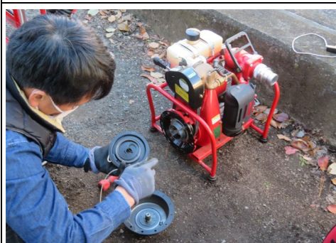
D級ポンプ修理の様子
