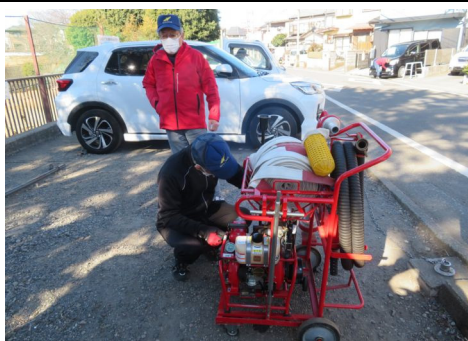
D級ポンプ点検の様子
