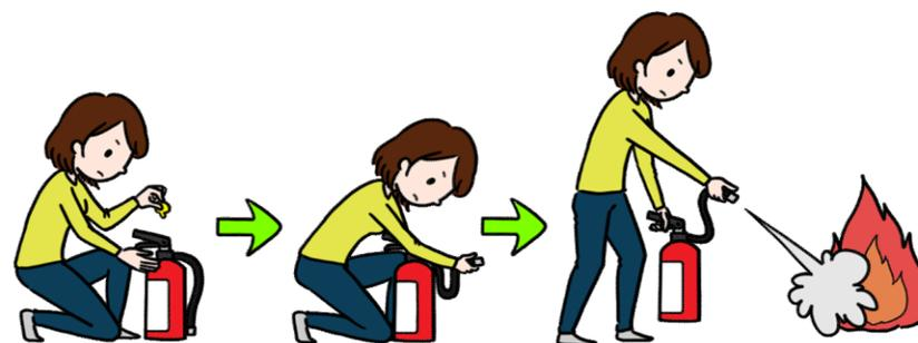
**火元を払うように消火剤を動かしながら、火が完全に消えるまで噴射し続ける。**
