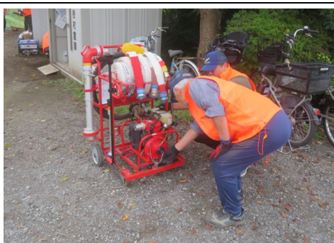
D級ポンプ点検の様子
