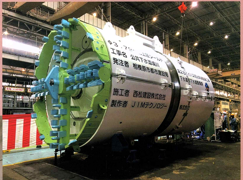
▲直径3.79mの穴を掘り進む泥土圧式シールドマシン(重量97t)
