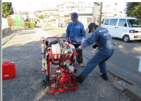
D級消火ポンプ点検の様子
